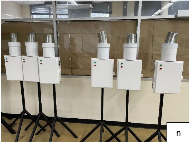
ภาพที่ 24 (ก) เครื่องกำจัดแมลงศัตรูพืชสำหรับเกษตรกรแม่นยำผ่านระบบสื่อสารไร้สาย (ข) ระบบการทำงานภายในของเครื่องกำจัดแมลง
