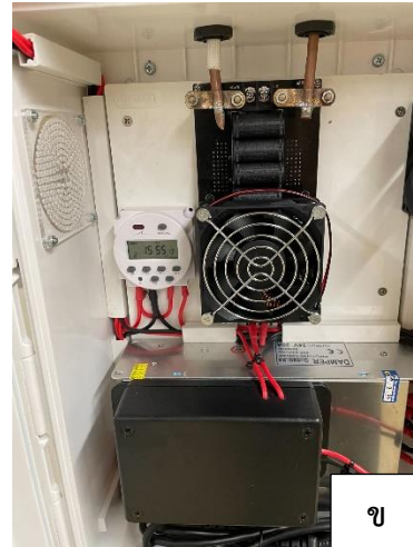
ภาพที่ 24 (ก) เครื่องกำจัดแมลงศัตรูพืชสำหรับเกษตรกรแม่นยำผ่านระบบสื่อสารไร้สาย (ข) ระบบการทำงานภายในของเครื่องกำจัดแมลง
