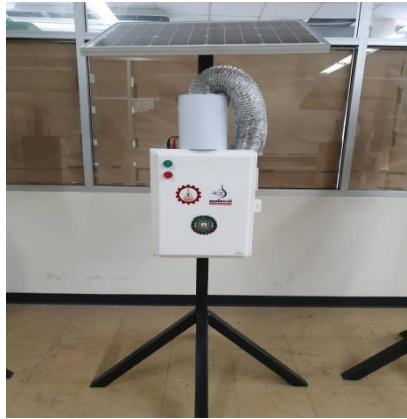
ภาพที่ 4 ลักษณะตัวเครื่องต้นแบบกำจัดแมลงศัตรูพืชสำหรับเกษตรกรแม่นยำผ่านระบบสื่อสารไร้สาย
