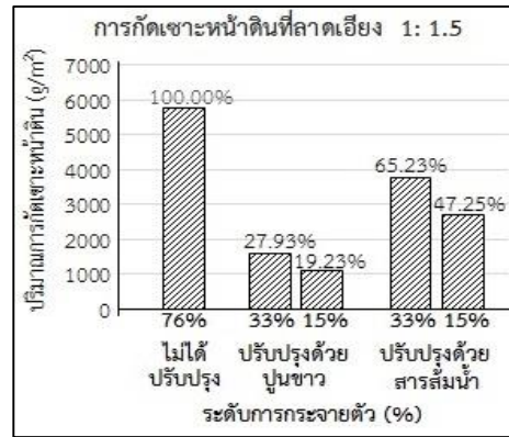
ภาพที่ 14 การกัดเซาะหน้าดินที่ระดับลาดเอียง 1: 1.5
