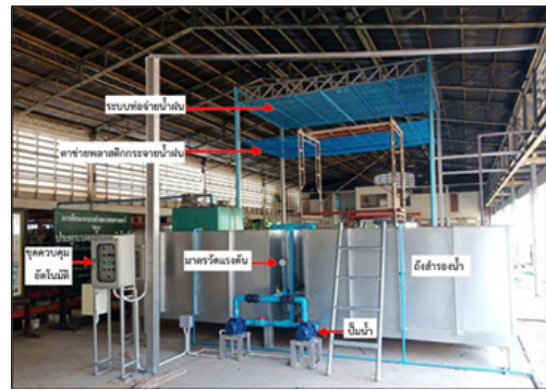
ภาพที่ ๖.๑ ชุดจำลองน้ำฝน
