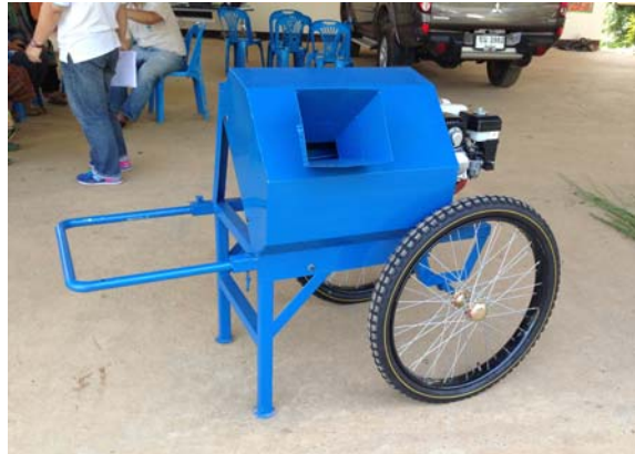
ภาพที่ 3.5 เครื่องลอกเปลือกเฮมพ์
