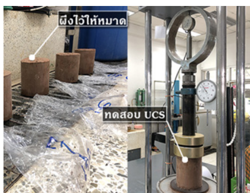
ภาพที่ ๖.๖ หลังจากแช่น้ำครบ ๒ ชั่วโมงนำขึ้นมาทิ้งไว้ให้หมาด แล้วทำการทดสอบหาค่ากำลังรับแรงอัด
