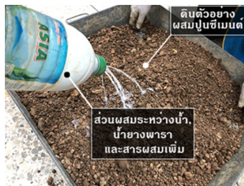
ภาพที่ ๖.๓ ผสมดินตัวอย่างกับซีเมนต์ให้เข้ากัน เติมน้ำผสมน้ำยางผสมสารผสมเพิ่มลงไปคลุกเคล้าให้เข้ากัน
