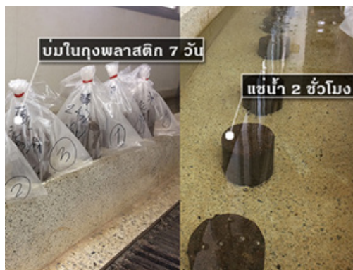
ภาพที่ ๖.๕ บ่มตัวอย่างในถุงพลาสติกจนครบ ๗ วันแล้วนำไปแช่น้ำ ๒ ชั่วโมง
