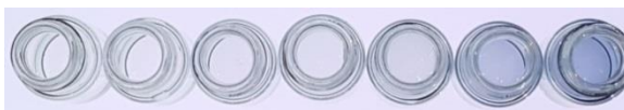
รูปที่ 1 สารละลายมาตรฐาน Gallic acid ในช่วง 0.005 – 0.01 mg/mL GAE
